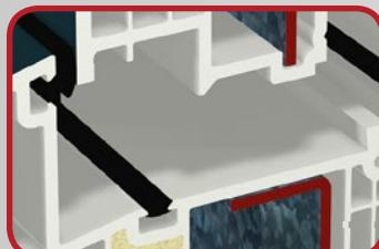
Средний уровень уплотнения в фальце рамы способствует улучшению теплоизоляционных свойств. Кроме того, он защищает фурнитуру от проникающей влаги и способствует лучшему открыванию створки особенно при низкой температуре за окном. Опционально систему S 9000 можно выбрать и в варианте с двумя уплотнениями.
