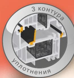
3 Три контура уплотнения повышают герметичность окна. При этом гибкое среднее уплотнение в фальце рамы является решающим для теплоизоляции, так как оно уменьшает тепловой поток в районе фальца.
